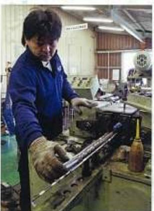
叩きながら絞るエージング加工の作業風景。金属鋼管のデザイン成形及び異形状一体成形技術で「平成14年度群馬県1社1技術選定」、丸角異形状パイプ加工で「平成16年度グッドデザインぐんま選定商品」、各認定
