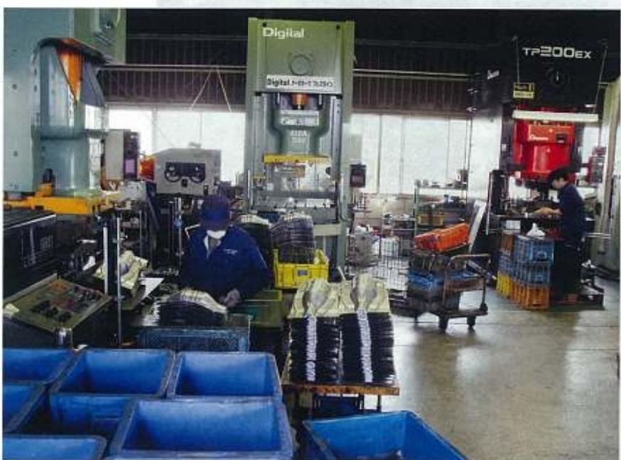
大型プレス機が並ぶ工場内。正面の機械が最新鋭のデジタルサーボプレスで、通常20%程度のロスが、同機では1%以下に抑えられるほか、NCレバーフィーダーとセットで厚板の量産加工も可能。高精度が要求される製品の加工に適している
